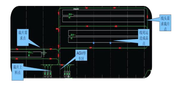
裁片区分空物料车与满物料车,当产线需求裁片时,按下呼叫按钮,裁片区按时间配送,AGV牵引满物料车至需求工位,并带回空物料车至裁片区空物料车摆放处。
